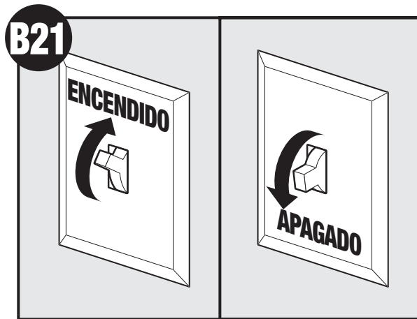
B21 Pruebe el motor. Si el motor no funciona, verifique la conexión del enchufe.
